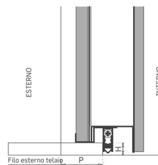
Se "P" =  $\phi$  < di 45 mm, antispiffero standard
